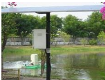
ภาพที่ 6 พลังงานแสงอาทิตย์แยกส่วนต้นกำลังคือแผงเซลล์ และชุดควบคุมไว้บนฝั่ง ที่มา : สำนักงานพัฒนาการวิจัยการเกษตร (2564ข)
