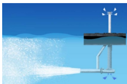
ภาพที่ 19 ระบบเติมอากาศแบบเวนจูรีชนิดติดตั้งกับทุ่นลอย
