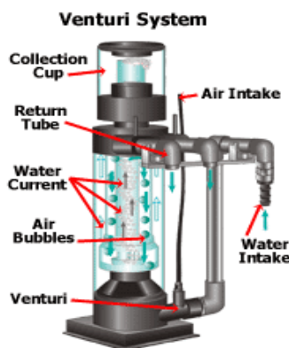
ภาพที่ 2 เครื่องโปรตีนสกินเมอร์รูปแบบ Venturi Protein Skimmer
